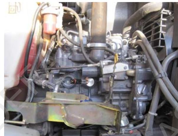
N Demonter frostpluggen og monter varmeren (1). Kontakten pekende **kl. 5**. Skjær ut et lite felt i plastdeksetet (2), slik at plug in kabelen kan monteres på varmeren. Fyll på godkjent kjølevæske og luft kjølesystemet godt iflg. motorfabrikantens spesifikasjoner. Kontroller for lekkasje.
