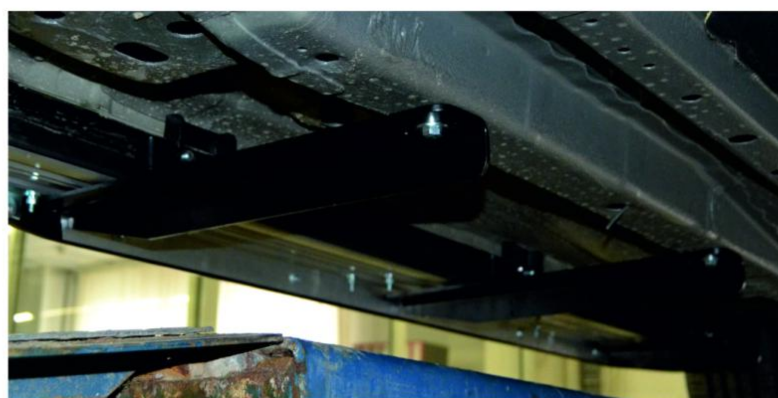
Рис. 2а - Установка передних кронштейнов
