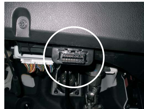
Отсоедините оригинальный разъем OBD от кронштейна и подключите прилагаемый кабель Y. Установите другой конец кабеля Y в кронштейн.
