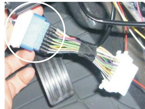
Отсоедините оригинальный разъём OBD от вилки и подсоедините входящий в комплект разветвительный кабель. Установите другой конец разветвительного кабеля в вилку.
